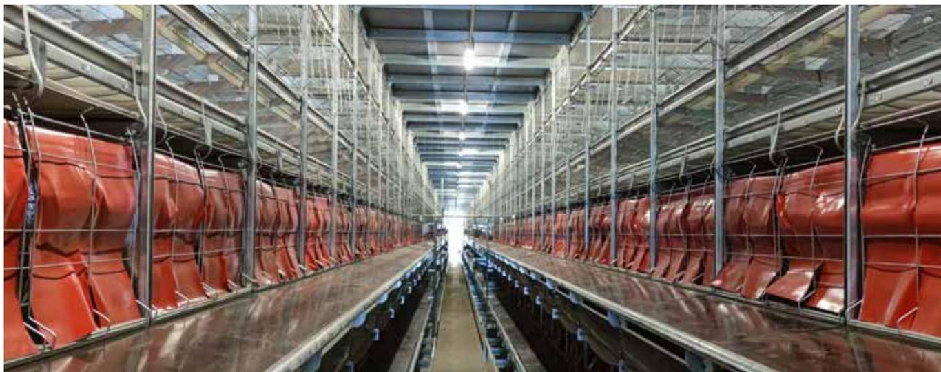
La leve **inclinación del fondo del nido** hace que los huevos se deslicen suavemente hacia la cinta de recogida, que está hecha de polipropileno perforado, un material que facilita la limpieza.
