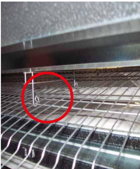
Вместе с тем, эта система "крепления и суппорта" создает жесткую связь с конструкцией батареи, придавая высокую устойчивость даже при возникновении поперечных нагрузок.
