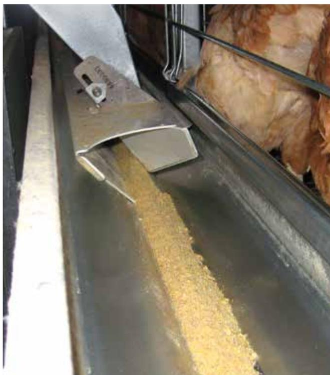
Кормушки из цинк-алюминиевого сплава толщиной 8/10 мм со специальным защищающим от разбрасывания профилем, разработанным специально для выравнивателя распределительной тележки корма.
