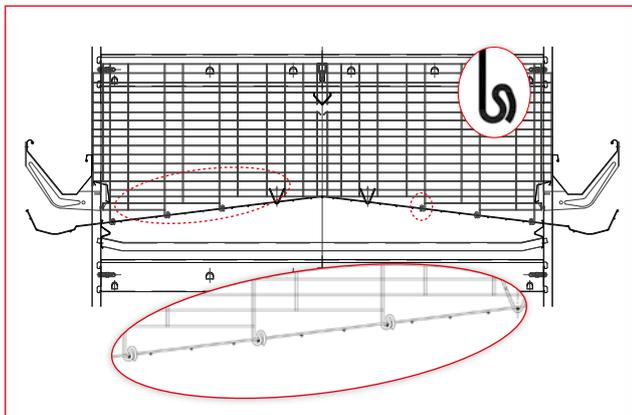
Благодаря своей технологии производства компания Фассо разработала проволочное горизонтальное поддержание пола, как продолжение проволоки перегородки, таким образом, предотвращая провисание пола, даже если клетка полная, то есть, предотвращается концентрация яйца в центре клетки. Оно разработано для облегчения монтажа и благодаря правильному распределению нагрузки для более длительной службы перегородки.
