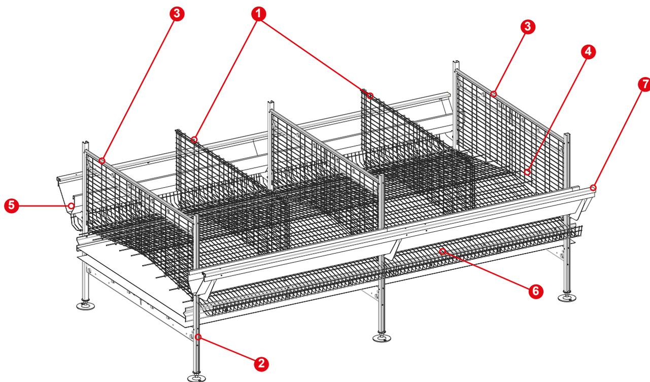
**1** Закругленная сверху перегородка облегчает движение ленты. Она оснащена строенными крючками для крепления продольного стержня.
