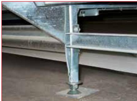
Специальная форма ножки в нижней части клетки обеспечивает более высокую устойчивость, в то время как регулируемая база позволяет компенсировать небольшие погрешности пола для достижения идеального уровня.
