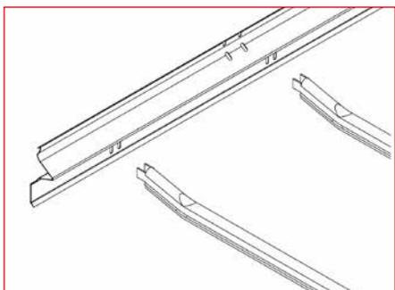
**Профиль специальной формы позволяет направлять ленту системы удаления помета.**
