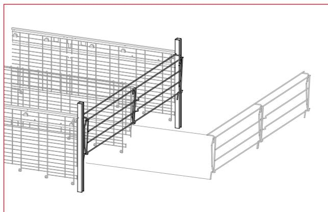
**Дверца скользящего типа крепится в специальную раму для обеспечения правильного скольжения, а также для предотвращения ее срыва с петель.**
