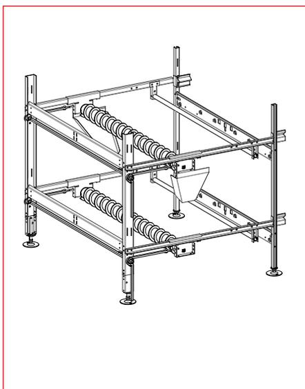
Фронтальная рама была разработана таким образом, чтобы облегчить проведение сервисных работ и регулировку ленты пометоудаления. Более того, что впоследствии снизить время монтажа, был разработан вал обратного хода ленты, который в тоже время выполняет функцию самоочистки от грязи. Грязь выходит только в одну сторону данного вала, исключая ее накопление в центре, что могло бы нарушить правильное функционирование системы пометоудаления.
