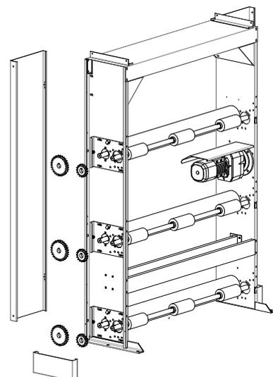
В важном узле системы пометоудаления установлены стальные зубчатые колеса, которые обеспечивают длительный срок службы, также они разработаны таким образом, чтобы облегчить проведение контроля и сервисное обслуживание.
