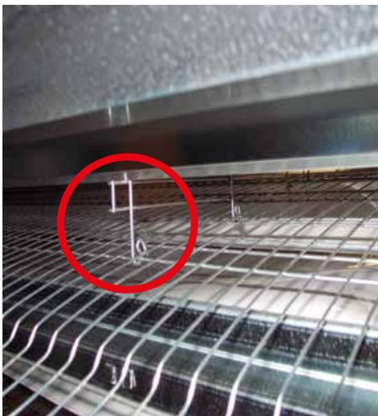
Al mismo tiempo, este sistema de “enganche y soporte” determina un acoplamiento rígido con la estructura de la batería, confiriendo gran estabilidad, incluso cuando se lo somete a esfuerzos transversales.
