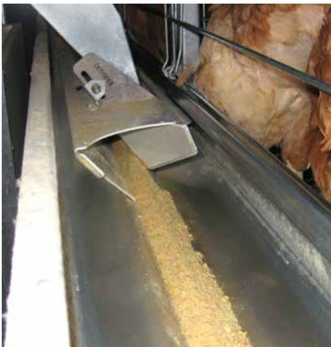
Comederos en aluzinc de 8/10 mm de espesor y un perfil especial anti derroche, diseñado específicamente para el nivelador del carro de distribución del pienso.
